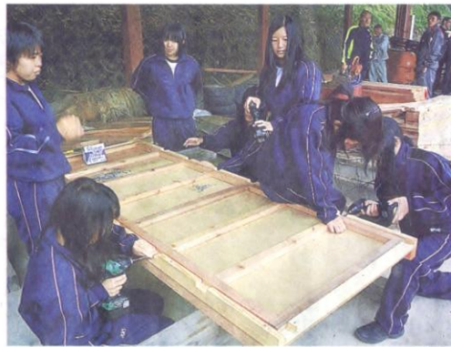
電動工具を使い、壁用パネルを仕上げ る高校生ら＝しそ森林組合千種支所
